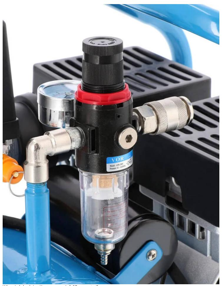
Wie wird der leise Kompressor L 6-95 gewartet? Nach jedem Gebrauch des Kompressors muss unbedingt das während des Gebrauchs entstehende Kondenswasser über dieses Ablassventil aus dem Kompressor abgelassen werden, denn auf diese Weise
